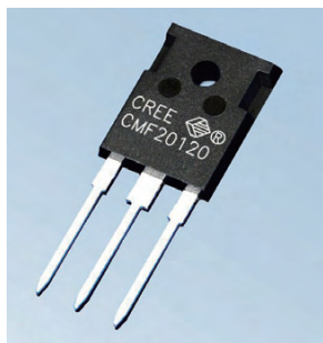
图1：SiC制MOSFET的量产品 科锐2011年1月宣布推出SiC制MOSFET。（摄影：科锐）
