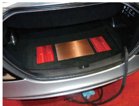
图2：梅赛德斯·奔驰“SLR McLaren Road Star”的后备箱配备的功率放大器 通过采用 SiC 制 SBD, 功放电路工作稳定, 有利于提高音质。
