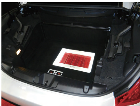
图1：标致“308CC”的后备箱配备的功率放大器 功率放大器使用的 SiC 制 SBD 由新日本无线与 Bewith 共同开发。
