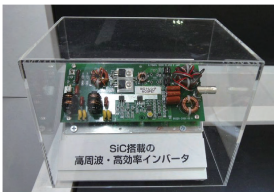
图3：配备于无线供电系统 发送端的逆变器电路中利用了 SiC 制沟道型 MOSFET。
