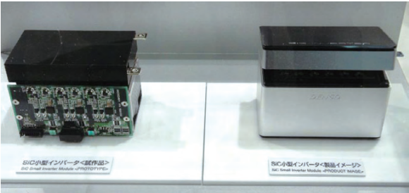
图1：电装试制的逆变器 左为试制品，右为放入箱内后的产品示意图。
