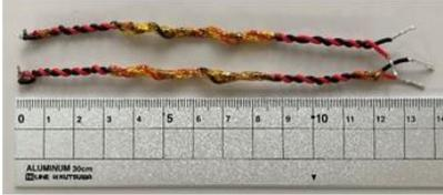
(d) Twisted shorter cable with 100 ohm damping
