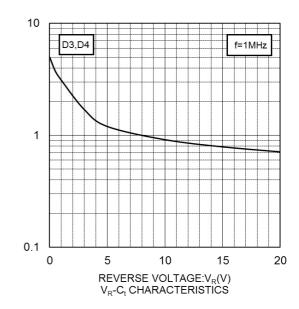
CAPACITANCE BETWEEN TERMINALS:C<sub>i</sub>(pF)
