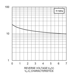
CAPACITANCE BETWEEN TERMINALS:C<sub>t</sub>(pF)
