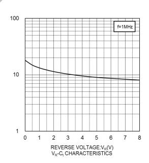
CAPACITANCE BETWEEN TERMINALS:C<sub>t</sub>(pF)
