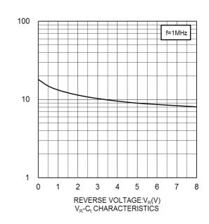
CAPACITANCE BETWEEN TERMINALS:C<sub>t</sub>(pF)
