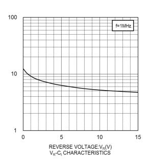
CAPACITANCE BETWEEN TERMINALS:C<sub>t</sub>(pF)
