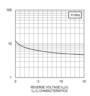
CAPACITANCE BETWEEN TERMINALS:C<sub>t</sub>(pF)
