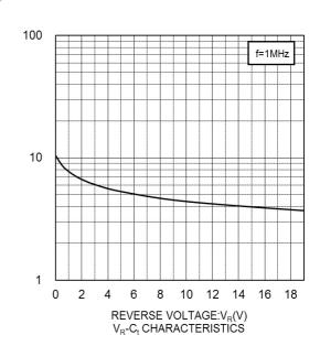
CAPACITANCE BETWEEN TERMINALS:C<sub>t</sub>(pF)
