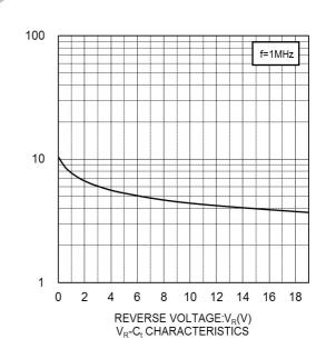
CAPACITANCE BETWEEN TERMINALS:C<sub>t</sub>(pF)
