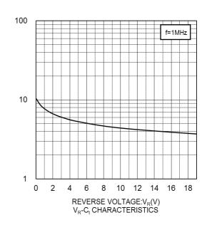
CAPACITANCE BETWEEN TERMINALS:C<sub>t</sub>(pF)
