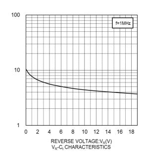
CAPACITANCE BETWEEN TERMINALS:C<sub>t</sub>(pF)
