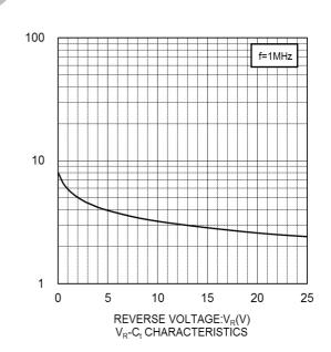
CAPACITANCE BETWEEN TERMINALS:C<sub>t</sub>(pF)
