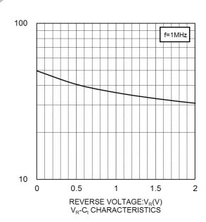
CAPACITANCE BETWEEN TERMINALS:C<sub>i</sub>(pF)
