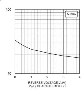
CAPACITANCE BETWEEN TERMINALS:C<sub>f</sub>(pF)
