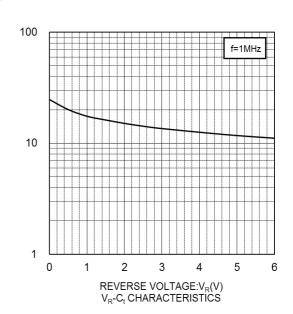
CAPACITANCE BETWEEN TERMINALS:C<sub>t</sub>(pF)
