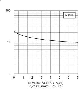
CAPACITANCE BETWEEN TERMINALS:C<sub>t</sub>(pF)
