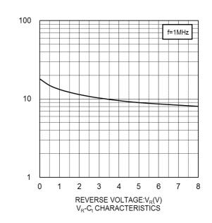
CAPACITANCE BETWEEN TERMINALS:C<sub>t</sub>(pF)
