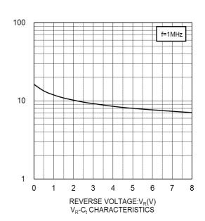
CAPACITANCE BETWEEN TERMINALS:C<sub>t</sub>(pF)
