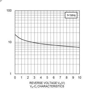
CAPACITANCE BETWEEN TERMINALS:C<sub>t</sub>(pF)
