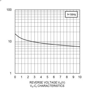
CAPACITANCE BETWEEN TERMINALS:C<sub>t</sub>(pF)
