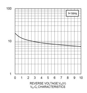
CAPACITANCE BETWEEN TERMINALS:C<sub>t</sub>(pF)
