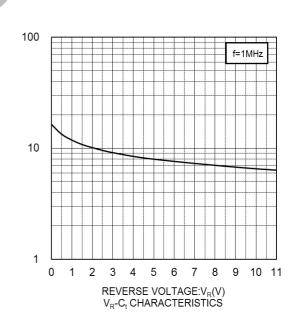
CAPACITANCE BETWEEN TERMINALS:C<sub>t</sub>(pF)
