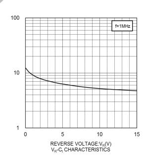
CAPACITANCE BETWEEN TERMINALS:C<sub>t</sub>(pF)
