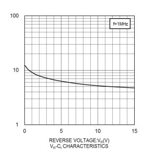
CAPACITANCE BETWEEN TERMINALS:C<sub>t</sub>(pF)
