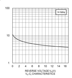
CAPACITANCE BETWEEN TERMINALS:C<sub>t</sub>(pF)
