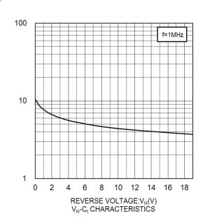
CAPACITANCE BETWEEN TERMINALS:C<sub>t</sub>(pF)
