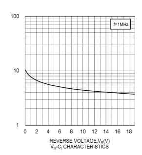
CAPACITANCE BETWEEN TERMINALS:C<sub>t</sub>(pF)
