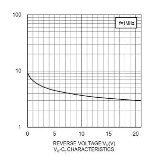
CAPACITANCE BETWEEN TERMINALS:C<sub>t</sub>(pF)
