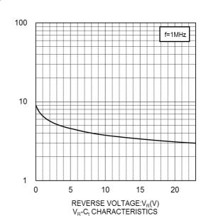
CAPACITANCE BETWEEN TERMINALS:C<sub>t</sub>(pF)
