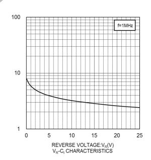
CAPACITANCE BETWEEN TERMINALS:C<sub>t</sub>(pF)
