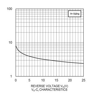
CAPACITANCE BETWEEN TERMINALS:C<sub>t</sub>(pF)
