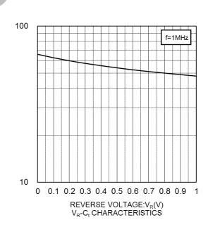
CAPACITANCE BETWEEN TERMINALS:C<sub>(</sub>(pF)
