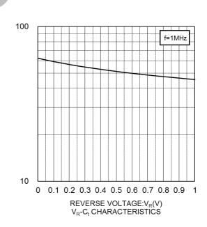
CAPACITANCE BETWEEN TERMINALS:C<sub>(</sub>(pF)
