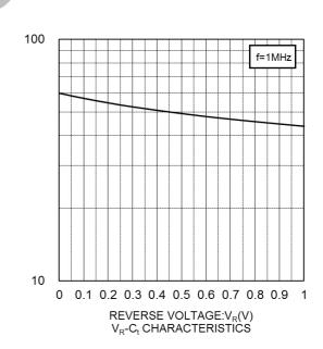
CAPACITANCE BETWEEN TERMINALS:C<sub>(</sub>(pF)
