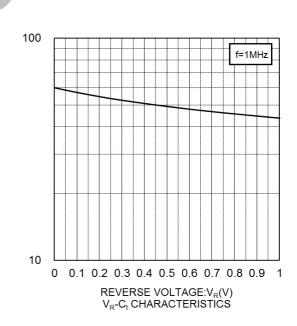
CAPACITANCE BETWEEN TERMINALS:C<sub>(</sub>(pF)
