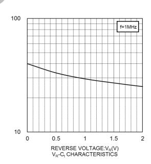
CAPACITANCE BETWEEN TERMINALS:C<sub>f</sub>(pF)
