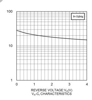
CAPACITANCE BETWEEN TERMINALS:C<sub>(</sub>(pF)
