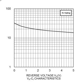
CAPACITANCE BETWEEN TERMINALS:C<sub>(</sub>(pF)
