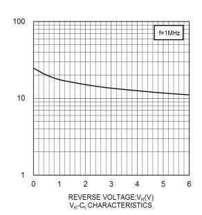
CAPACITANCE BETWEEN TERMINALS:C<sub>t</sub>(pF)
