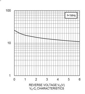
CAPACITANCE BETWEEN TERMINALS:C<sub>t</sub>(pF)
