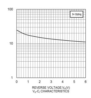
CAPACITANCE BETWEEN TERMINALS:C<sub>t</sub>(pF)
