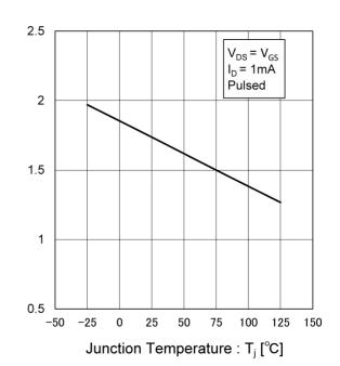
Gate Threshold Voltage :  $V_{GS(th)}\left[V\right]$
