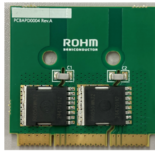
Figure 4. 一次側 MOSFET 子基板
