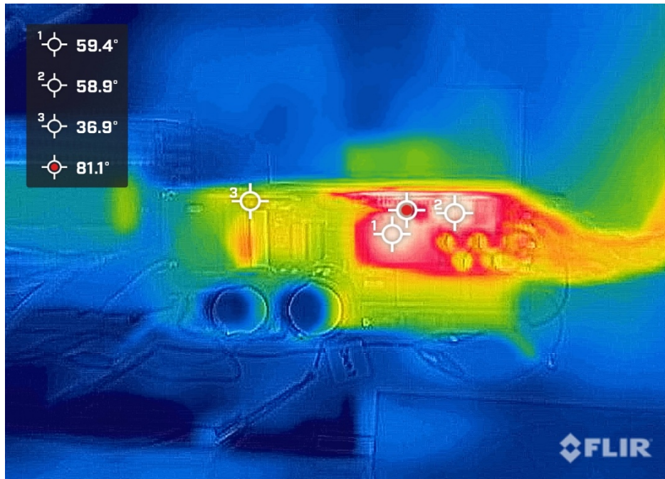
Figure 9. 表面温度分布(定格負荷時)
