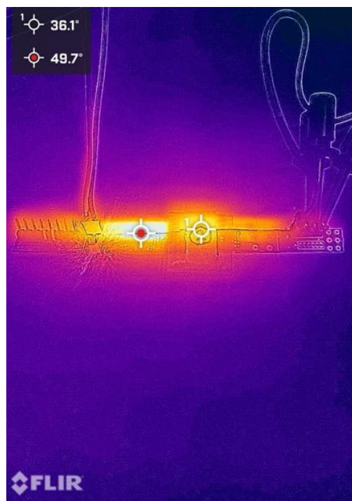
図 16：動作時の基板温度
