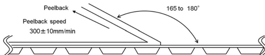
図2 カバーテープ剥離強度試験方法
