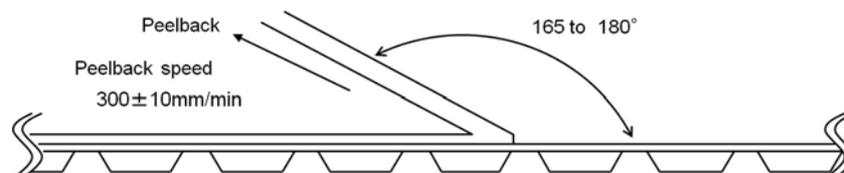
図2 カバーテープ剥離強度試験方法
