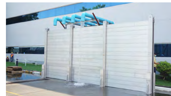
止水壁の組み立て訓練
