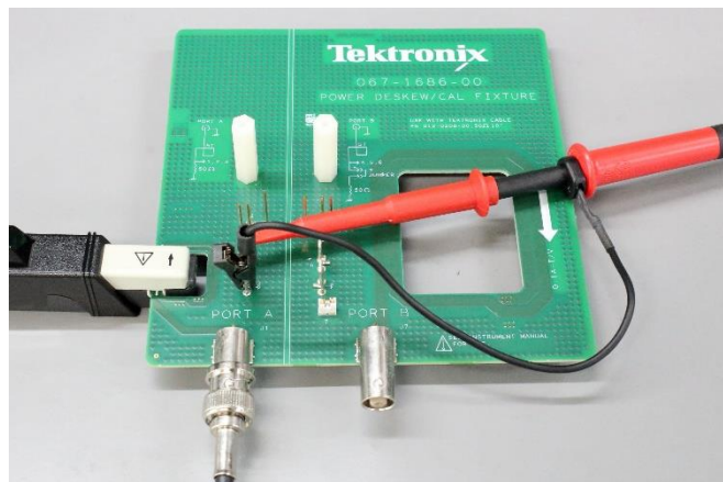
Figure 5. Tektronix 社製 デスキューフィクスチャ
