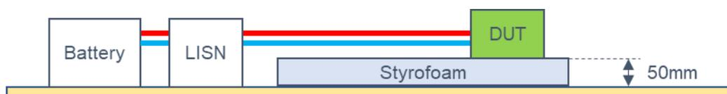
Figure 4. 放射ノイズ測定系側面図
